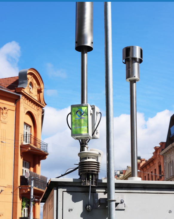
Senzorová jednotka ENVISens při finálním testování.
